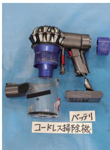
写真 13-1 焼損した機器の状況
