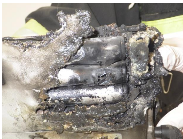
写真 13-2 ノートパソコン用の バッテリーパック焼損状況
