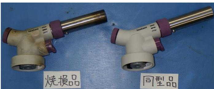
写真 13-1 ボタンガストーチバーナの焼損状況
