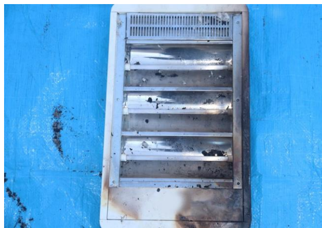
写真 18-2 電気ストーブの焼損状況
