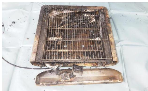
写真 18-4 電気ストーブの焼損状況
