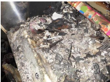
写真 19-3 ガスコンロの焼損状況
