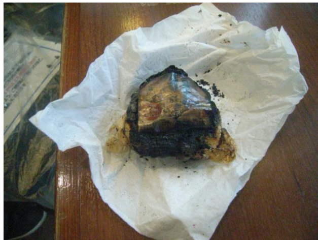
写真 20-4 加熱していた食品の焼損状況
