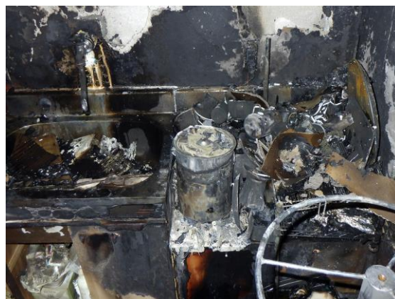
写真 20-3 焼損した電気ポットの状況
