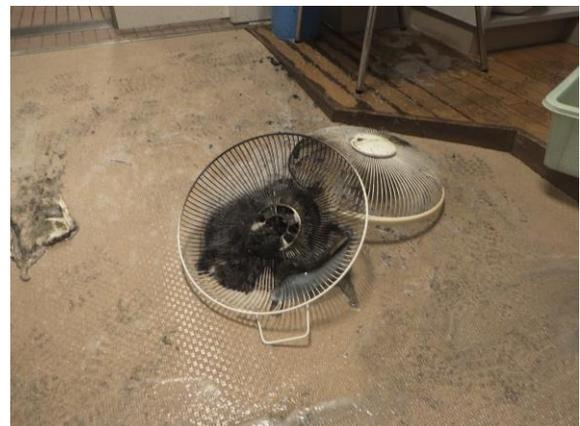
写真 22-2 扇風機の焼損状況
