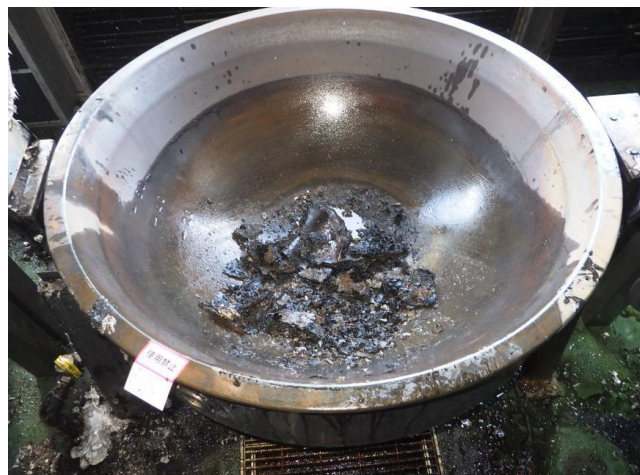
写真 23-2 ガス回転釜の状況
