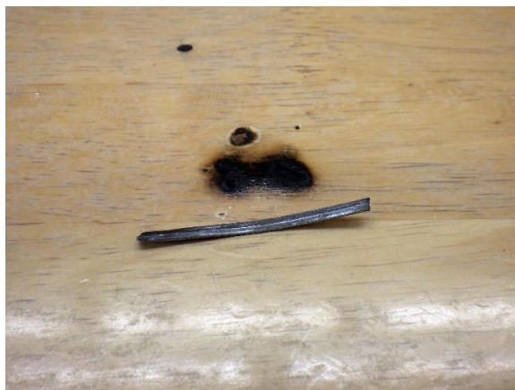
写真 24-4 机の焼損状況 2
