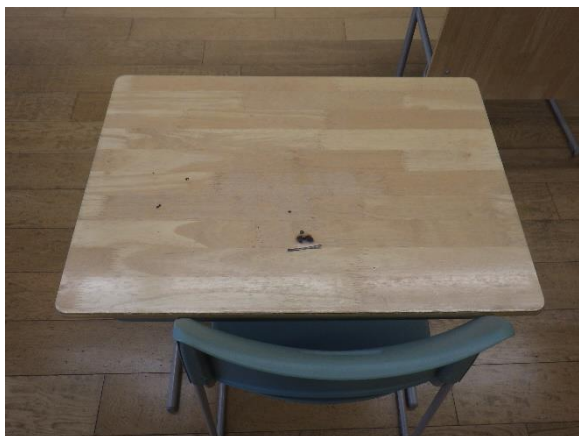
写真 24-3 机の焼損状況 1
