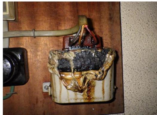
写真 24-2 コンデンサの焼損状況
