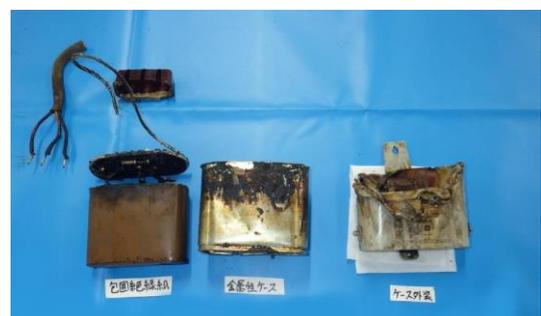
写真 24-3 コンデンサの焼損状況
