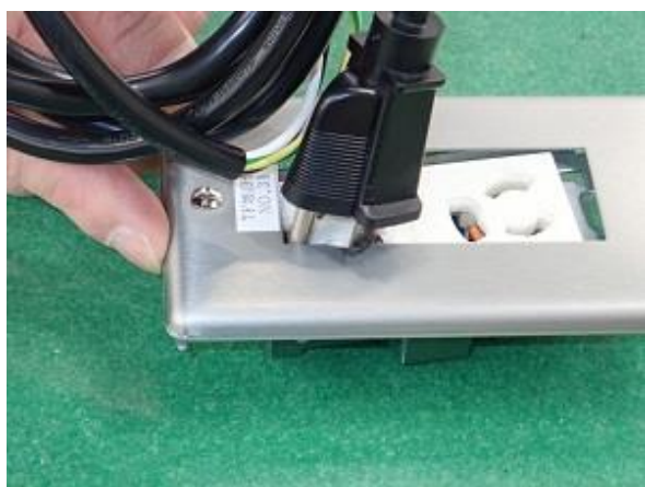
写真 27-4 コンセントカバーとプラグの 接触状況の再現
