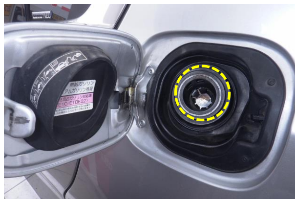
写真 28-4 給油口の焼損状況
