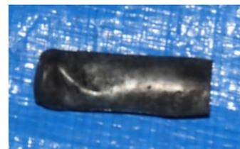
写真 29-4 火源となったリチウムイオン電池
