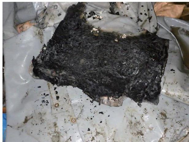
写真 10-2 焼損した生石灰の状況
