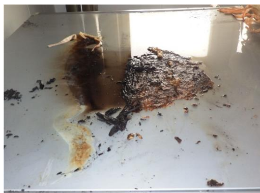
写真 30-2 ガス衣類乾燥機の天板上の状況
