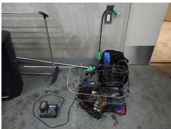
写真 30-3 焼損したバッテリーの状況
