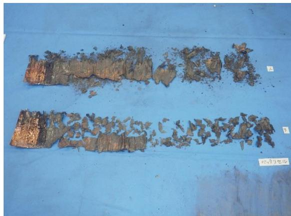
写真 6-6 焼損したバッテリーの状況
