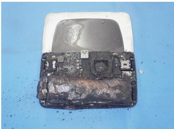
写真 6-5 モバイルパソコンの焼損状況
