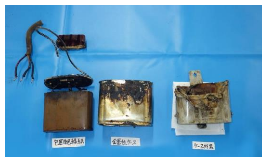
写真 24-3 コンデンサの焼損状況
