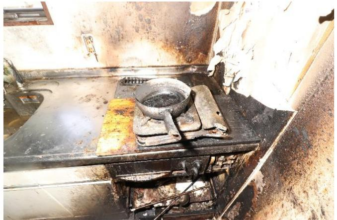
写真 9-4 使用していたカセットコンロの復元状況
