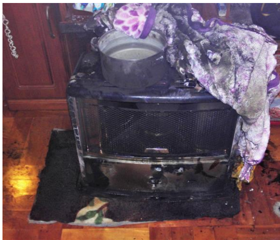
写真 8-1 石油ストーブの焼損状況
