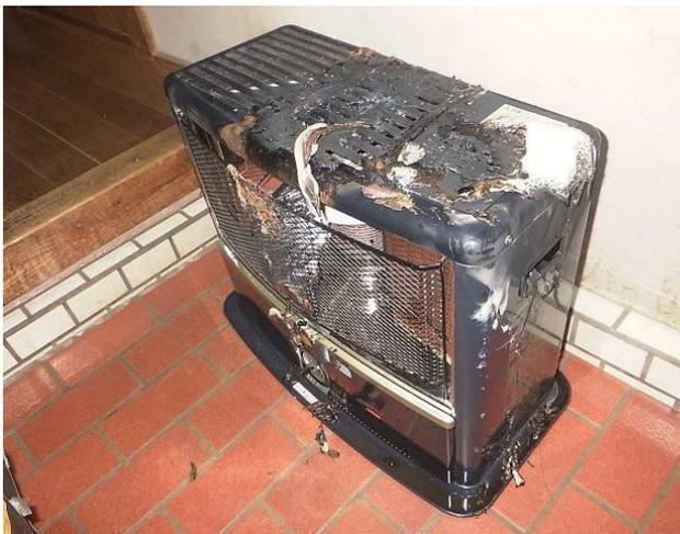
写真 8-3 焼損した石油ストーブの状況
