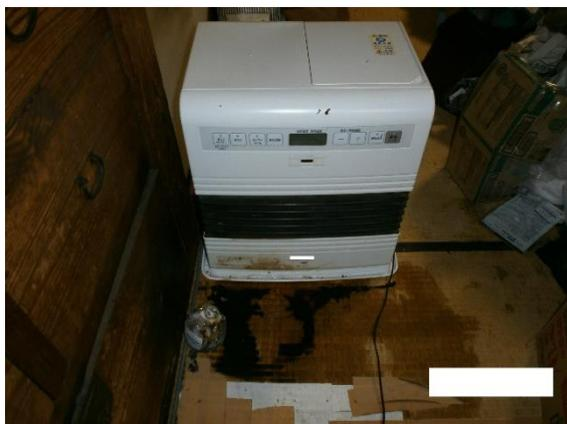
写真 8-1 出火箇所の焼損状況
