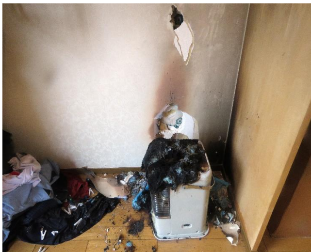
写真 8-3 焼損した石油ストーブの状況
