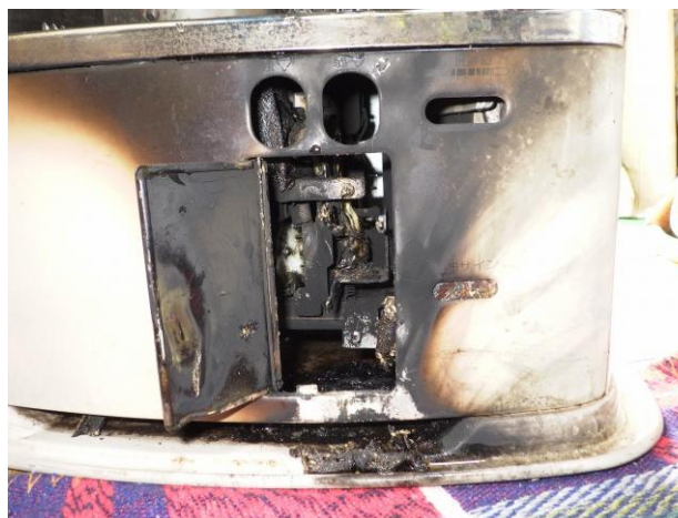
写真 8-2 操作扉内部の焼損状況
