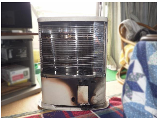
写真 8-1 石油ストーブの焼損状況
