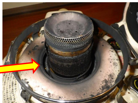
写真 8-4 燃焼部分の状況 (芯外筒がなく芯が見えている)
