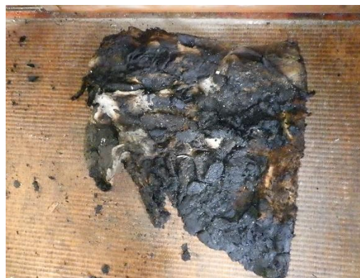
写真 14-5 座布団の焼損状況
