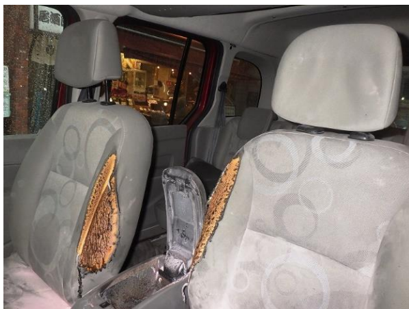
写真 4-3 焼損したフロントシートの状況
