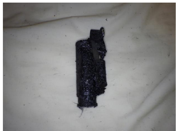
写真 4-4 焼損したライターの状況
