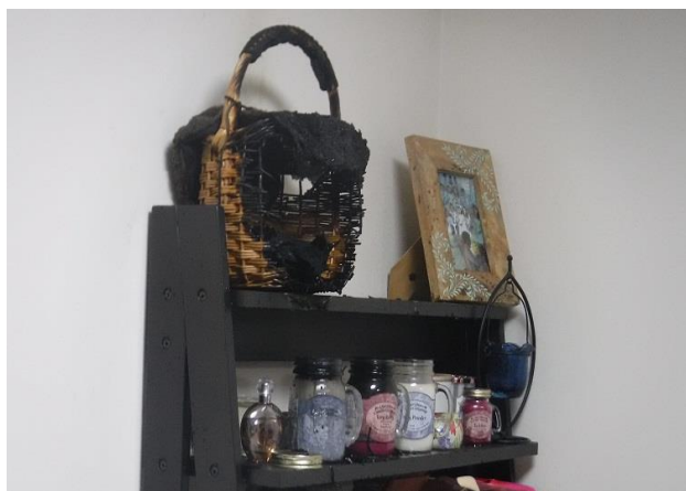
写真 5-1 棚及び藤かごの焼損状況
