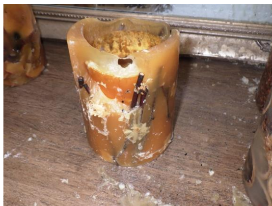
写真 5-2 アロマキャンドルの焼損状況
