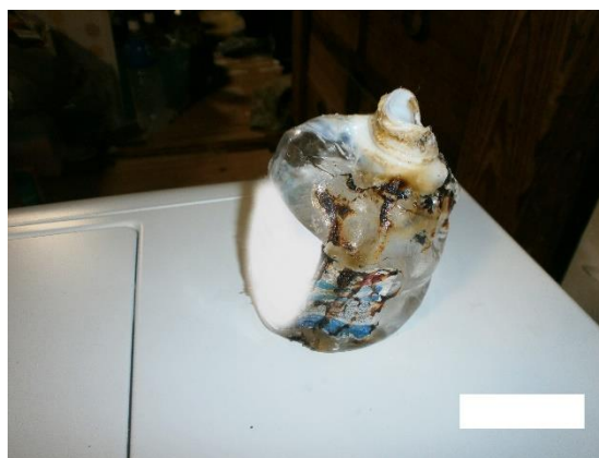
写真 8-2 焼損したアルコールジェル ボトルの状況
