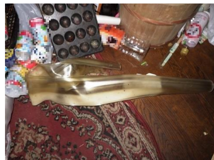
写真 11-7 溶融した照明カバー
