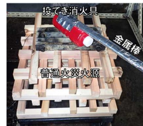
図7 消火具の取付状況
