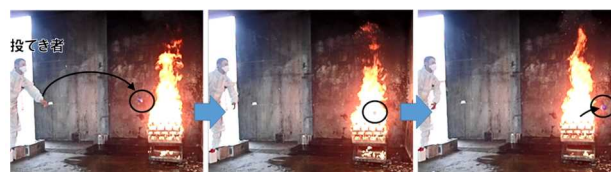
図 32 投てき消火具が火源に当たるも割れない様子
