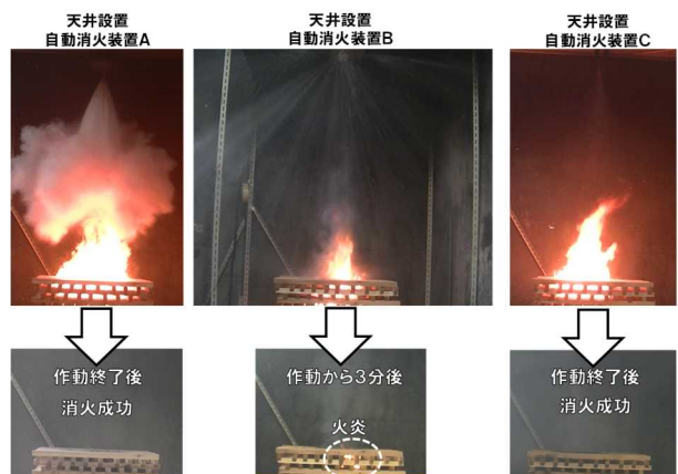
図 28 自動消火装置による普通自動消火状況
