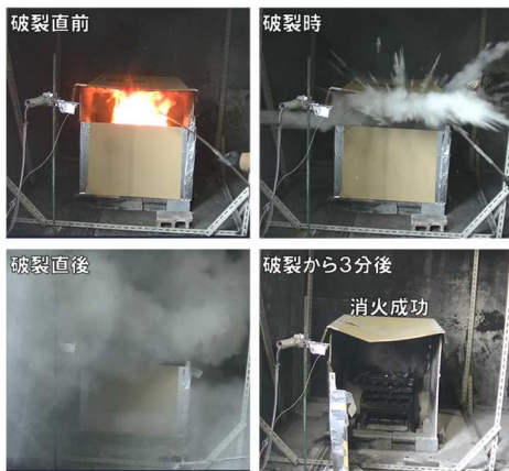
図 19 ボックス内消火状況
