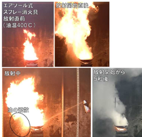
図 24 油火災火源の消火状況
