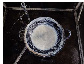
図35 鍋内の油が酸化した状況
