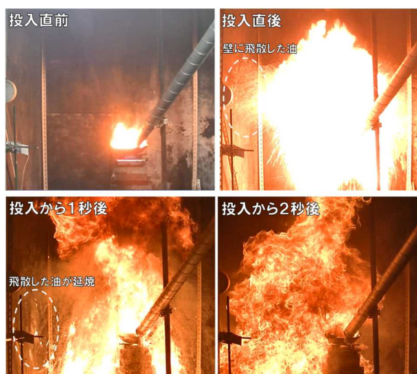
図 41 発火油への投入状況
