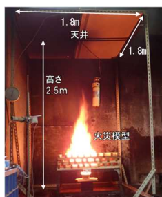
図2 火源燃焼状況
