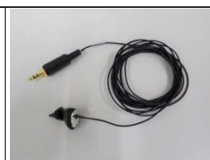
写真 3 耳栓型温度センサ
