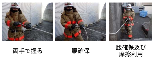
図13 検索ロープ確保時の耐荷重
