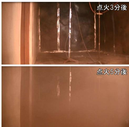
図 10 クリブ燃焼時の隣室の状況
