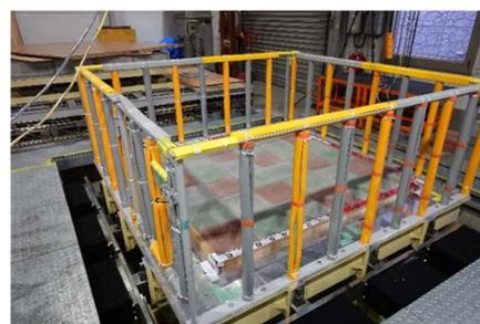
写真1 振動発生装置
