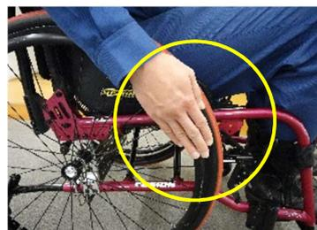
写真12 手ブレーキによる制動
