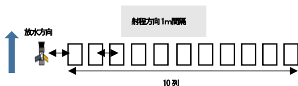
図5 真上方向への噴霧放水の実験設定（平面図）
