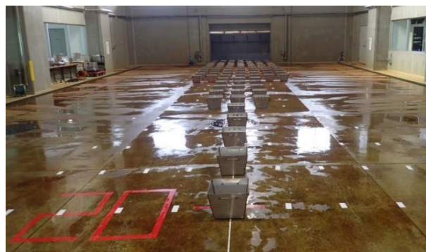
写真6 直状放水の採水枡設定状況
