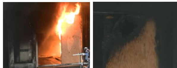
図１３ 実験②の壁材（合板）燃焼状況 （左図：点火３分後、右図：消火後）
