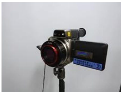
写真2 赤外線サーモカメラ
