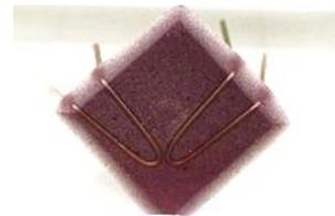
写真4 銅線を埋め込んだ模擬サンプルの外観
