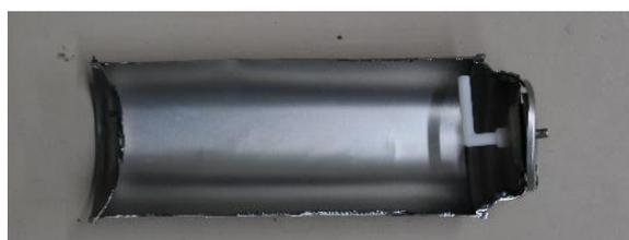
写真 11 C B缶の断面
