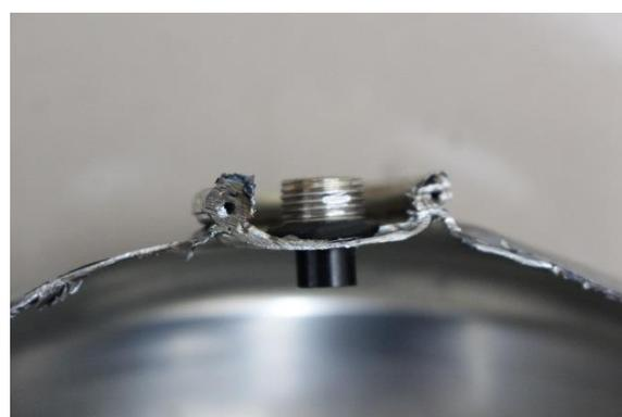
写真 14 O D缶のパイプ先端
