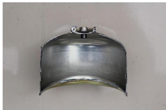
写真 13 O D缶の断面
