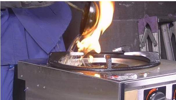
図 29 五徳先端部に 220℃の油を 100mL 滴下した時の着火状況
