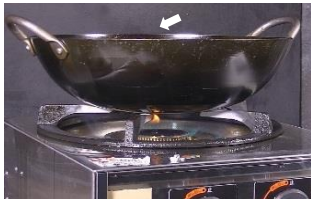
図31 中華鍋の外面を伝った菜種油が五徳の先端において着火した状況
