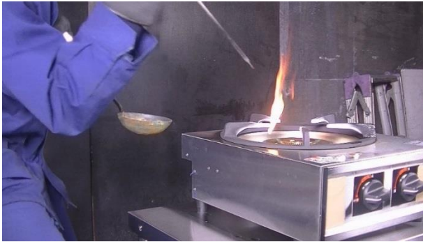
図 28 五徳先端部に 20℃、0.03mL の油を滴下した時の着火状況
