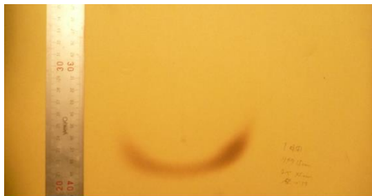
図 29 過大鍋ずらし検証②加熱後の仕上げ状況
