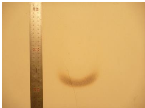
図 24 過大鍋ずらし加熱後の仕上げ状況 (ケイカル板離隔距離 8 cm)
