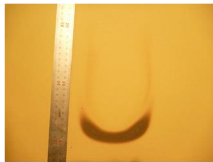
図 19 過大鍋ずらし加熱後の仕上げ状況 （石膏ボード離隔距離 8 cm）
