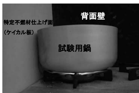
図 13 ケイカル板仕上げ加熱時の状況
