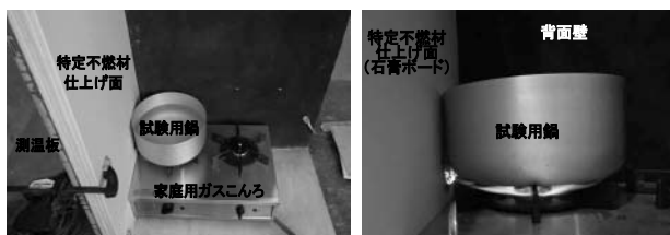
図6 石膏ボード仕上げ加熱状況 (左：全体、右：拡大)
