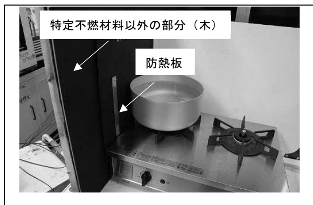
図7 特定不燃材料以外の仕上げ部分(木)の温度測定
