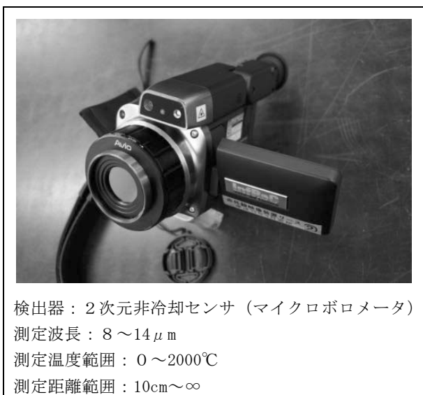
図4 赤外線熱画像カメラ外観及び仕様
