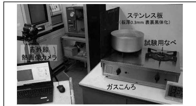
図5 ステンレス板防熱板受熱環境の実験状況
