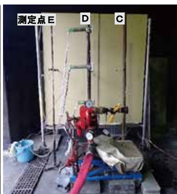
写真5 放水装置設定状況
