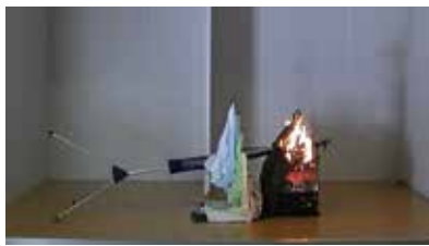
写真15 ピンチハンガーがストーブ上に転倒し、着火
