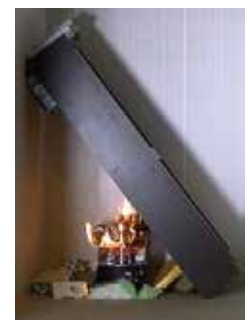
写真11 本棚内可燃物 写真12 可燃物が接触し出火
